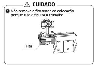
Deslize o amortecedor (lateral conduzida) para dentro da guia (lateral conduzida).
