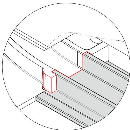
Certifique-se de que a base da placa conecte o trilho de forma firme e mantenha-os paralelos e alinhados.
