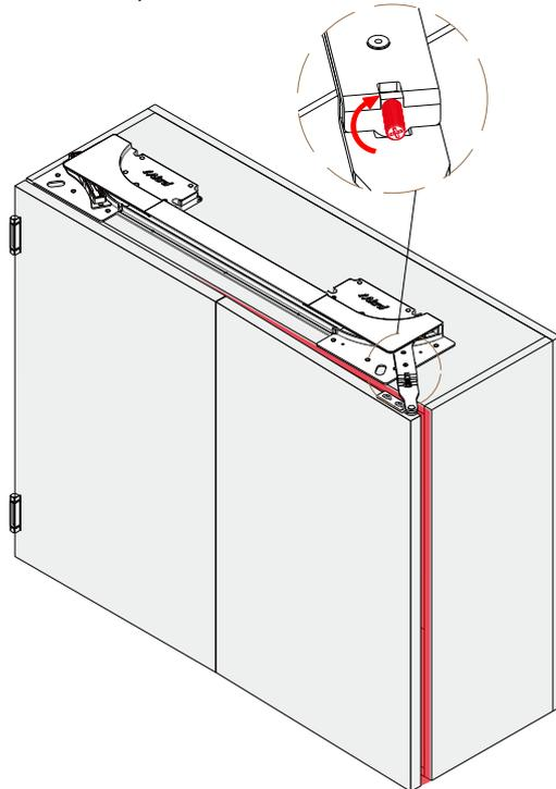
Quando os dois painéis da porta de dobrar não se alinharem com o armário, use uma chave de fenda para ajustar os parafusos no sentido anti-horário até que os painéis da porta se ajustem ao armário..
