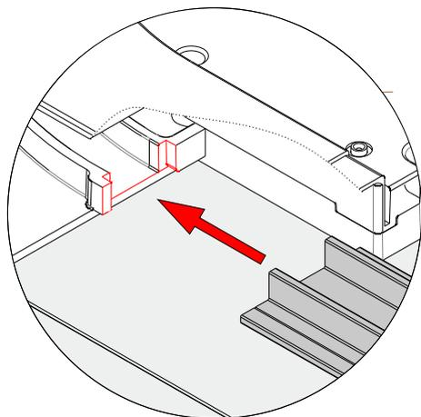
Deslize o trilho guia para a posição fixa da base da caixa do trilho guia à esquerda.
