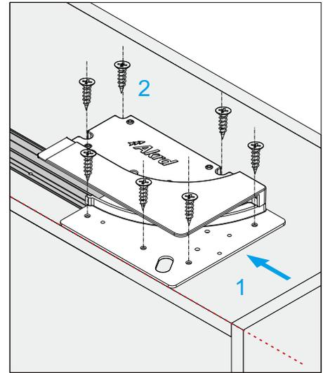
1. Deslize a caixa do trilho guia à direita para conectar o trilho. Certifique-se de que a base da placa conecte o trilho de forma firme e mantenha-os paralelos e alinhados. A borda frontal da caixa deve ser paralela à borda do painel superior.
